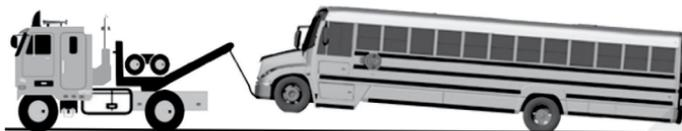
Figure 27 - Remorquage par l'avant du véhicule
