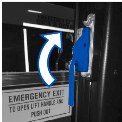
Figure 9 - Fenêtre de secours
