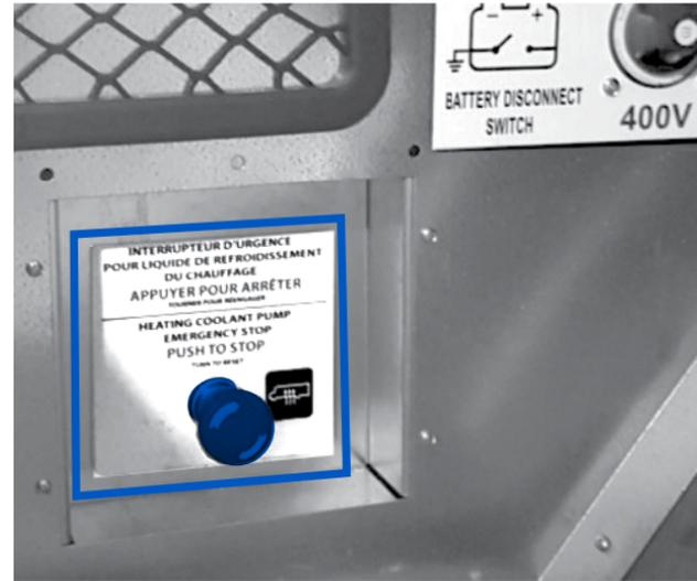
Figure 18 - Bouton d'arrêt d'urgence du système de chauffage
