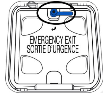
Figure 5 - Trappe d'évacuation par le toit
