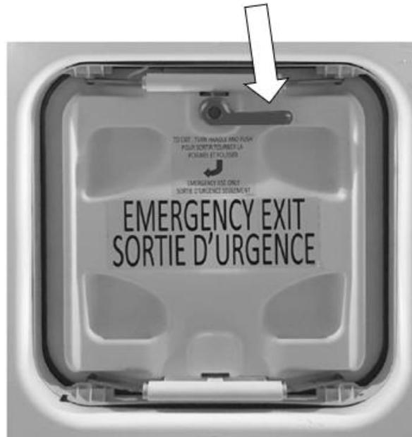
*Figure 3 - Trappe d'évacuation du toit (si équipée)*
