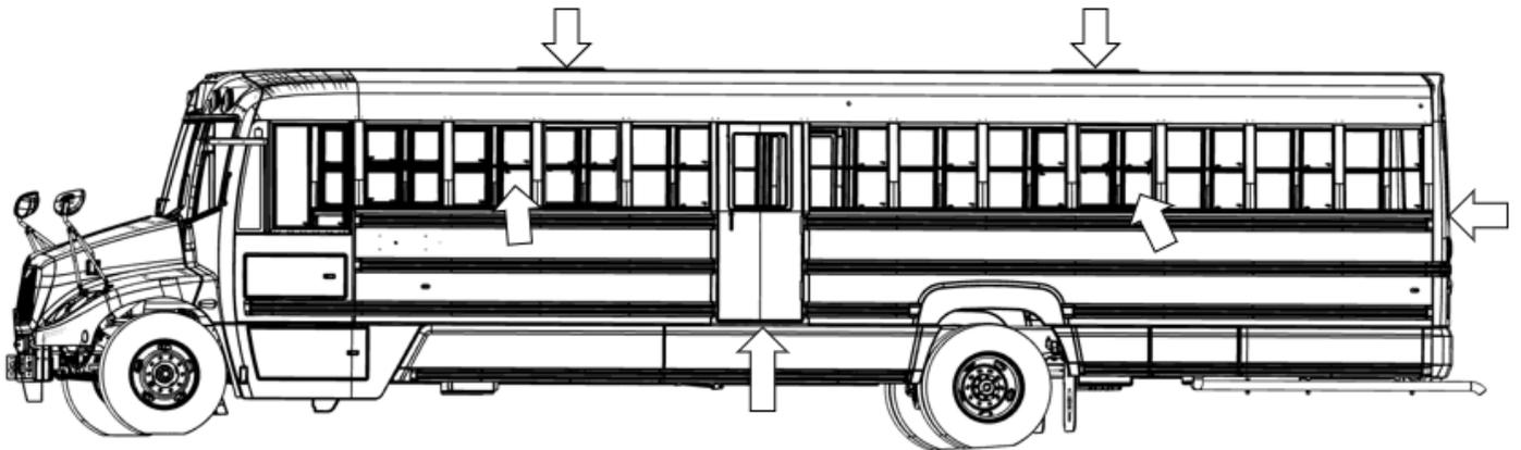
Figure 1 - Emplacement des sorties de secours
