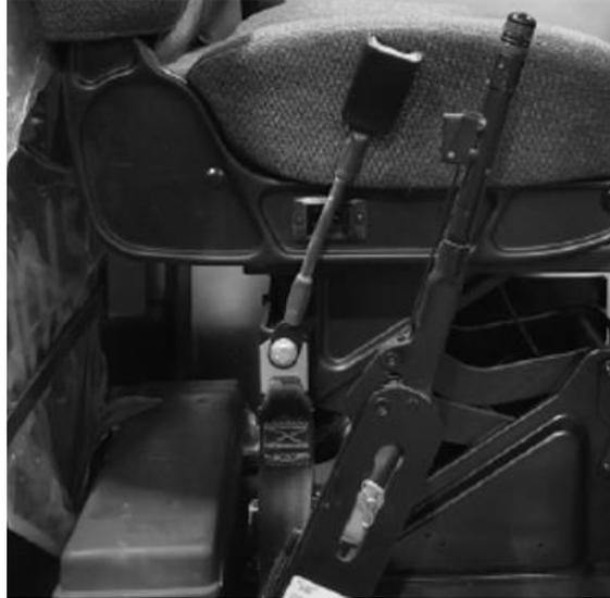
Figure 2 - Ceinture de sécurité de l'opérateur
