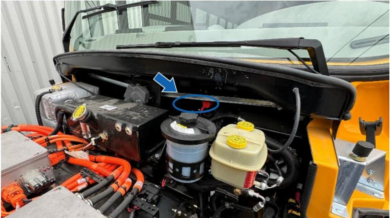
Figure 1 - Emplacement des bornes sur la cloison pare-feu
