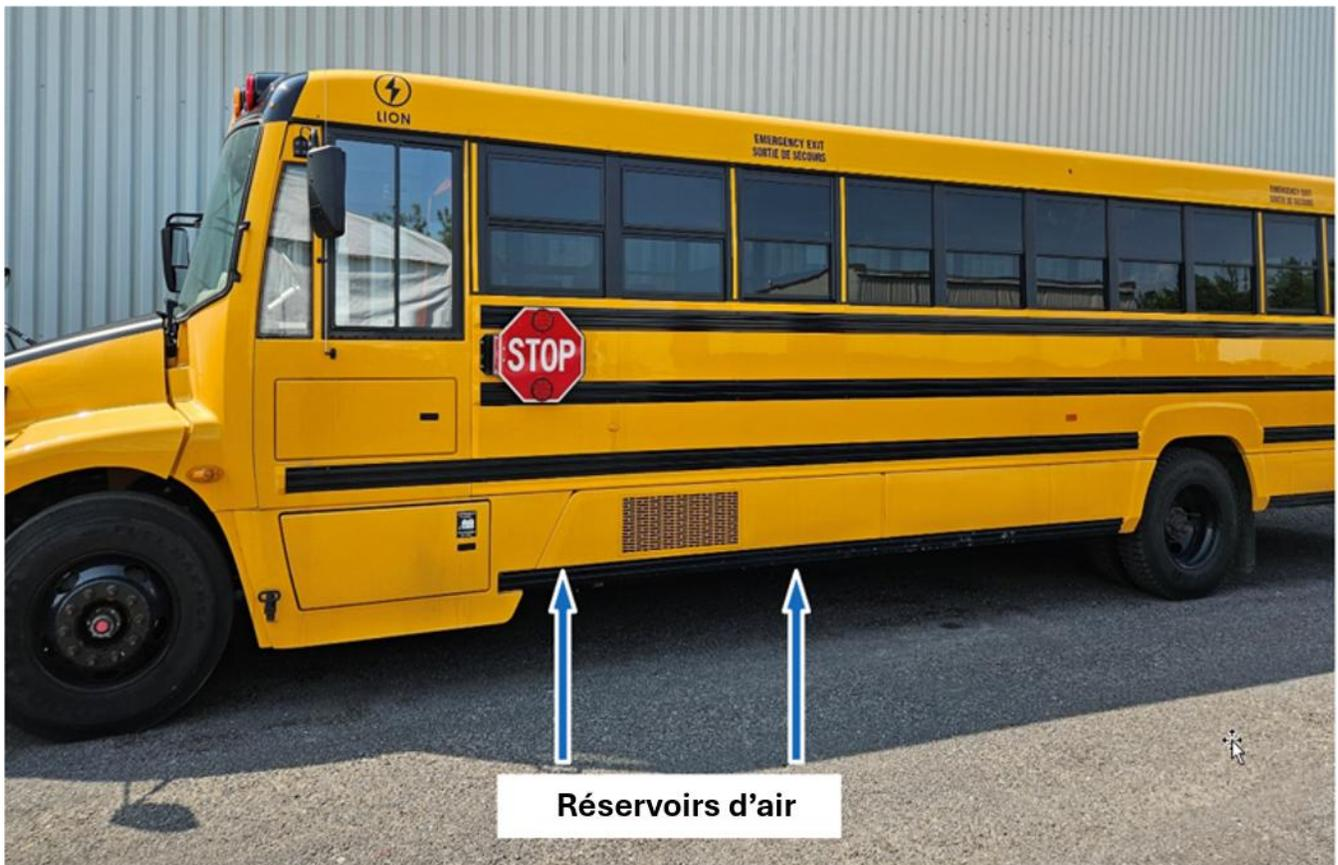
Figure 3 - Emplacement des réservoirs d'air
