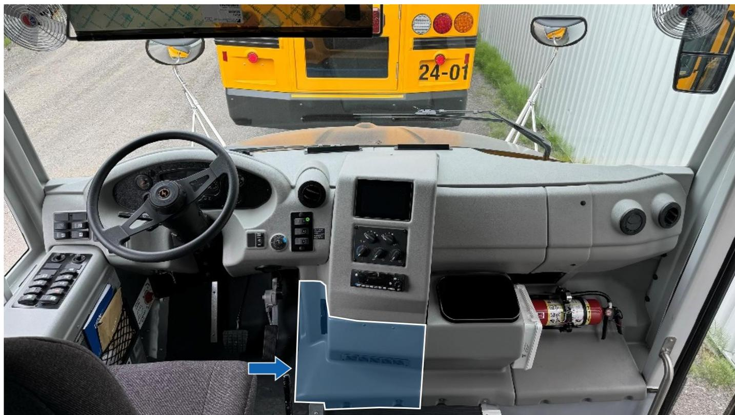
Figure 13 – Panneau à démonter
