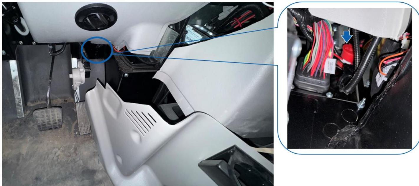
*Figure 15 – Emplacement des bornes intérieures*
