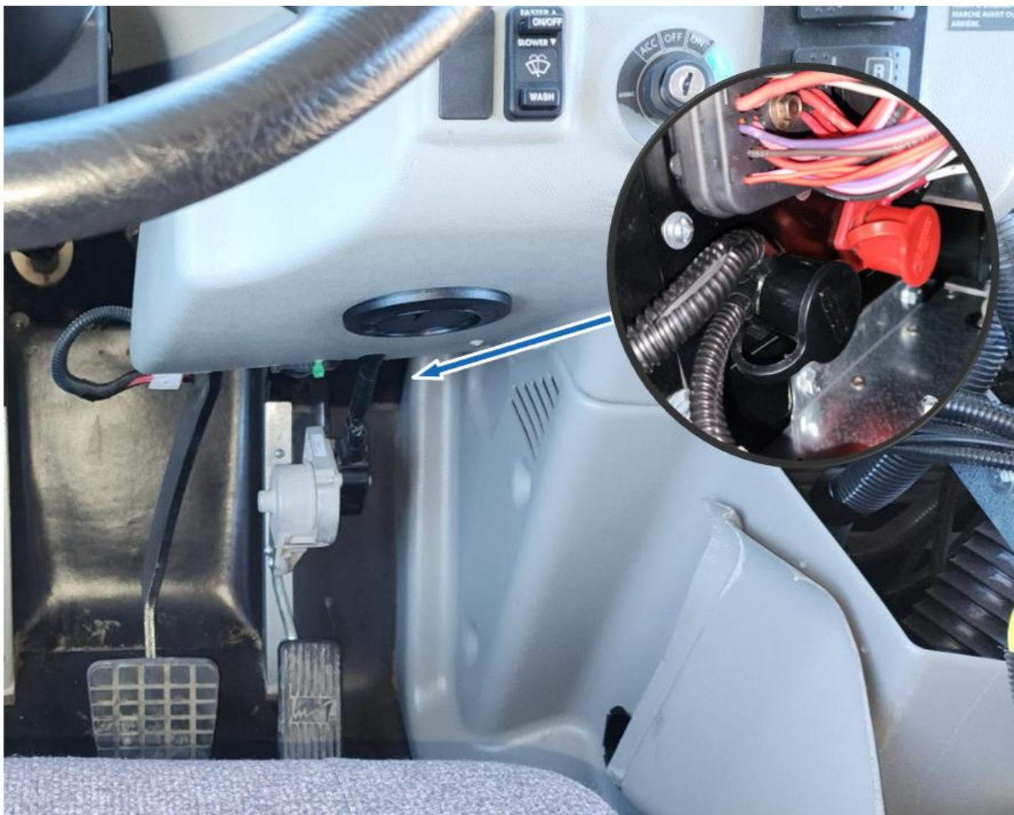
Figure 22 – Bornes passe-cloison intérieures
