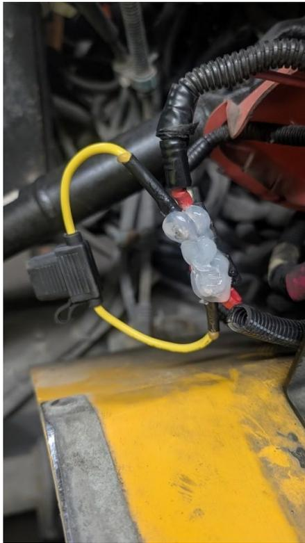
Remplir avec de la graisse diélectrique.
