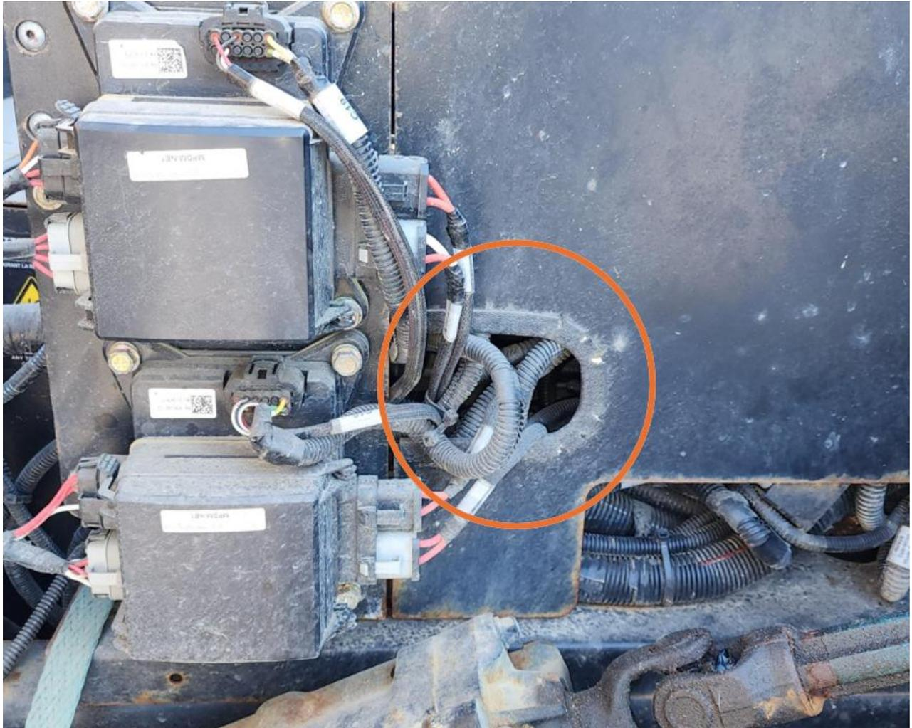
Figure 16 – Câblage de la plaque accessoires.
