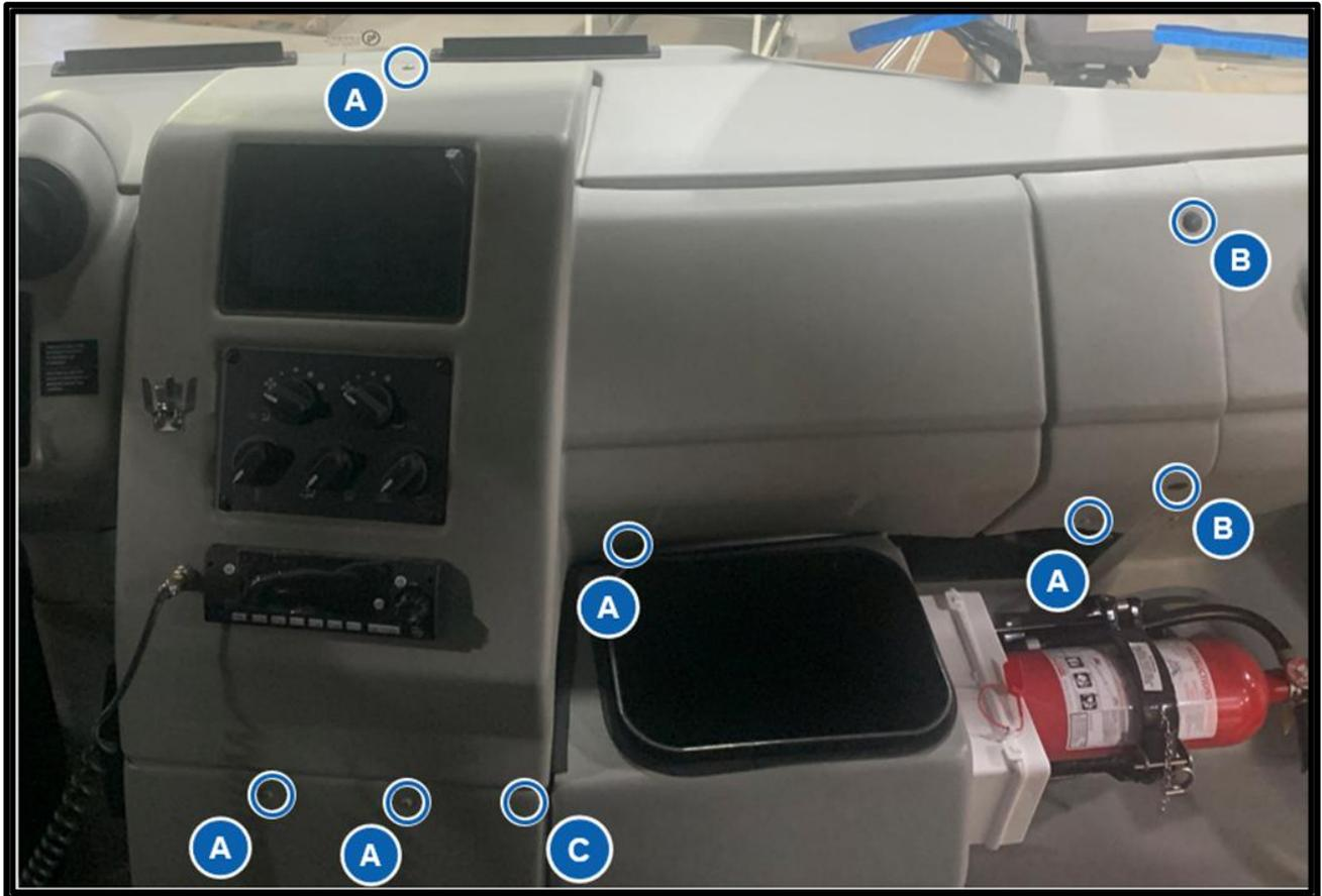
Figure 6 – Fixations de la console centrale
