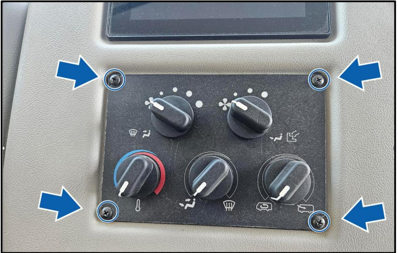
Figure 1 – Vis du panneau de commande du système CVC
